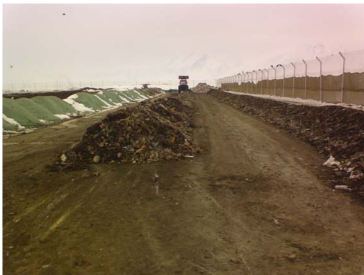
شکل ۱- توده‌های کمپوست در کارخانه کمپوست خمین و استفاده از کاورهای نمدی
